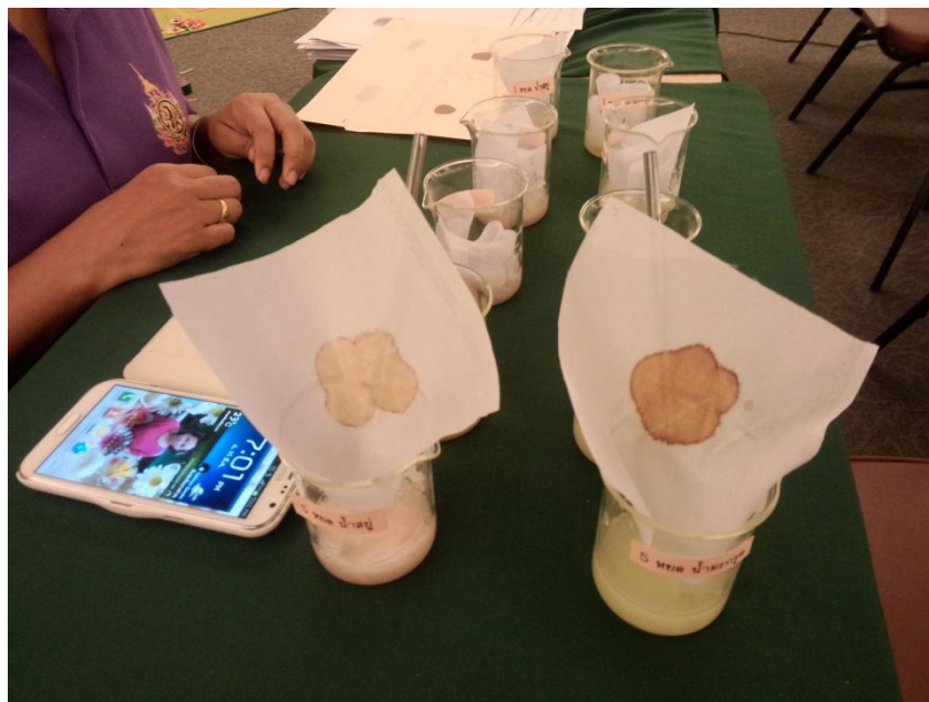
ภาพที่ 15 เปรียบเทียบหยดสารไอโอดีน จำนวน 5 หยด แขนในน้ำมะกรูดและน้ำสบู่ เวลา 10 นาที แล้วสังเกตคราบไอโอดีน
