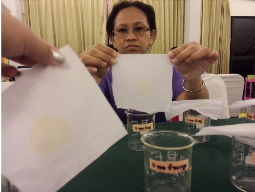
ภาพที่ 16 เปรียบเทียบหยดสารไอโอดีน จำนวน 5 หยด แขนในน้ำมะกรูดและน้ำสบู่ เวลา 15 นาที แล้วสังเกตคราบไอโอดีน
