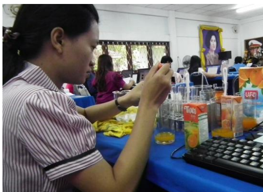
หยดน้ำส้มคั้น 100% ลงในสารละลายสีน้ำเงิน
