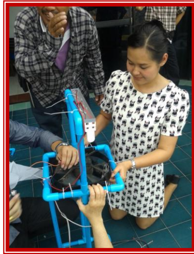
ภาพที่ 9 การเดินสายไฟของหลอดไฟกับพัดลมดูดอากาศ
